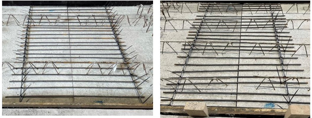
Foto 6.1 Proefstuk KV2 (links) en KV4 (rechts) voor het storten van de druklaag
