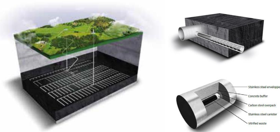
Figuur 6 OPERA concept voor de eindberging van radioactief afval in Boomse klei
